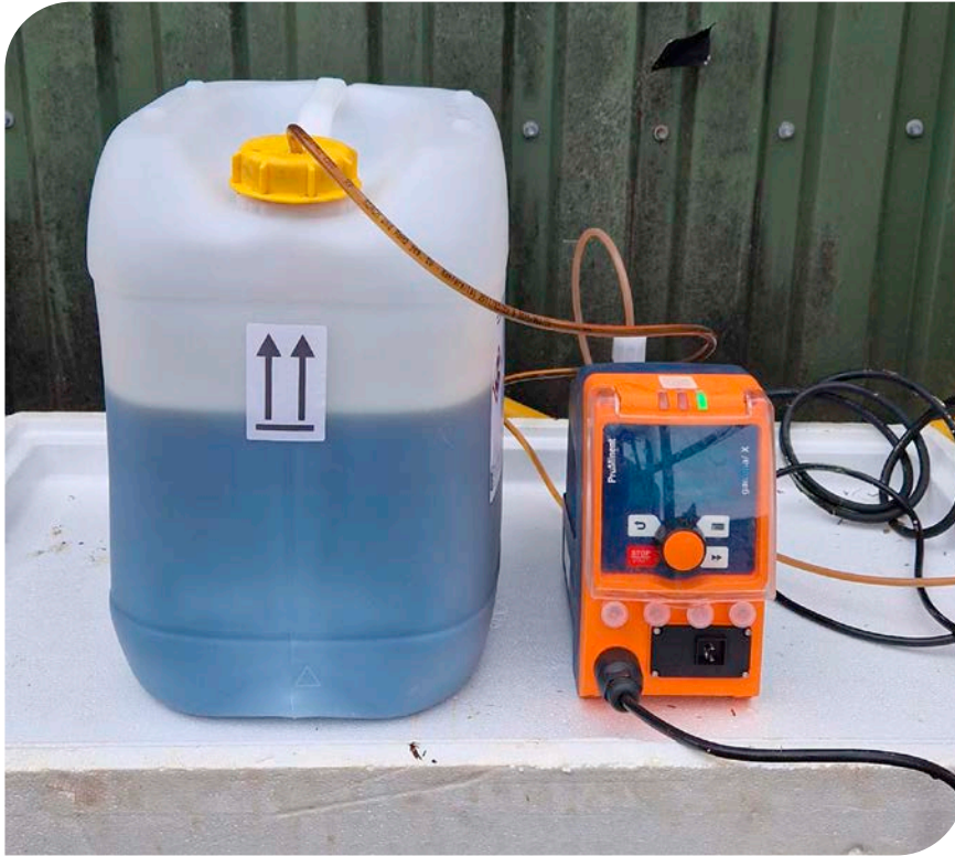
Abbildung 4: Pumpe zur Dosierung der Enzympräparate
